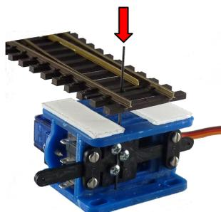
Enfoncer la tringle au ras de la traverse et serrer modérément les 3 vis
