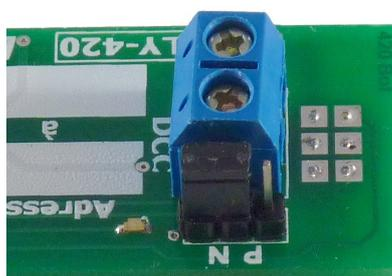
Pendant la manipulation du cavalier on évitera de mettre les doigts sur les pastilles du circuit imprimé, ce qui risquerait un dysfonctionnement du circuit. Le cas échéant une mise hors tension sera nécessaire.
